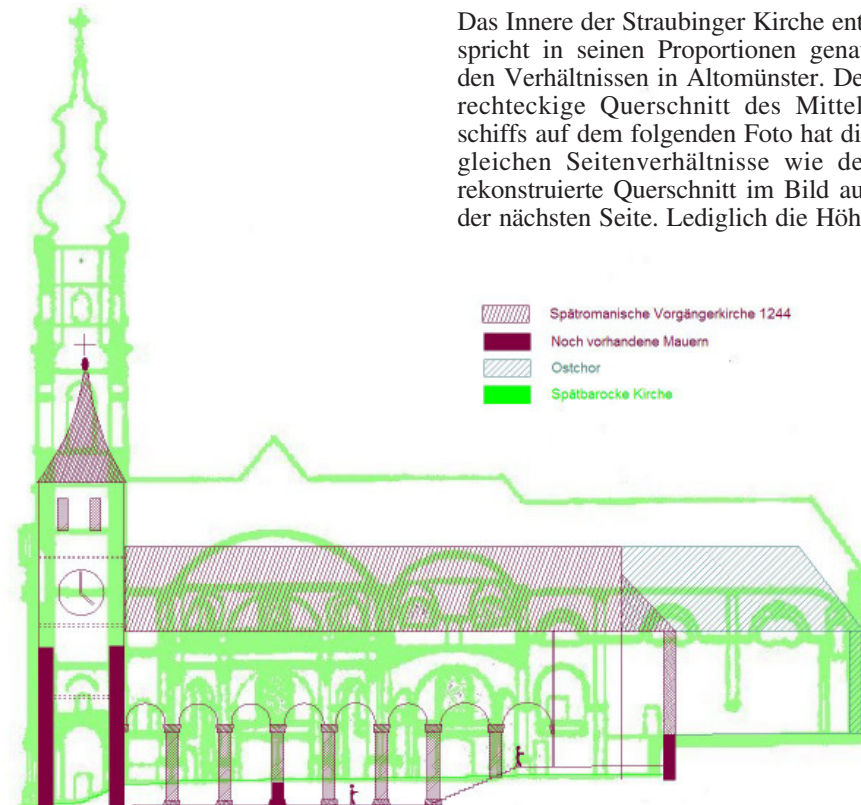
Längsschnitt der heutigen Kirche (hellgrün) mit Rekonstruktion der romanischen Vorgängerkirche (violett).
