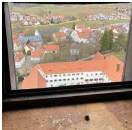
Leuchtschraube von einer älteren Vermessung vor 1990 für Messgeräte am nördlichen Fenster der Turmstube im Kirchturm von St. Alto, Altomünster, Quelle: K.P. Zeyer
